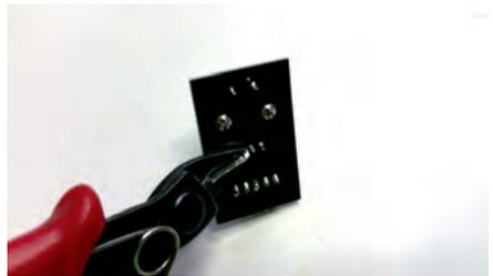
Rechts neben dem Hauptanschluß-Block finden Sie auf der HeatBox-platine den 2-poligen Anschluss für optionale Lüfter. ***Diese sind gem. der aufgedruckten Polarität anzuschließen***, der Betriebsstrom sollte 200 mA nicht überschreiten (Anlaufstrom sollte unter 0,5 A bleiben ).
