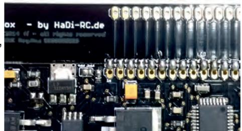
Dem Bausatz liegen gerade- und abgewinkelte Stiftleisten bei. Dies ermöglicht je nach Einbaumöglichkeit eine flachere Gesamtbauweise. Löten Sie zuerst einen Kontakt einer Leiste an, damit eine akurate Ausrichtung noch möglich ist. Erst danach verlöten Sie die restlichen Kontakte.
