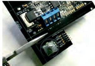
Zum etwaigen kürzen der Platine brechen Sie die eingeritzten Sektionen mit einer breiten Kombi-Zange vorsichtig ab. Ebenso können die Zusatzplatinen noch etwas gekürzt werden (Bruch-Ritzung vorhanden)
